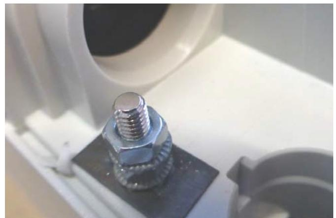
An diesem Pin besteht die Möglichkeit, andere Geräte aus den Anwendungen mit der Erdung zu verbinden. Dies kann auch im Falle von Verbesserungen bei EMV-Messungen helfen.
