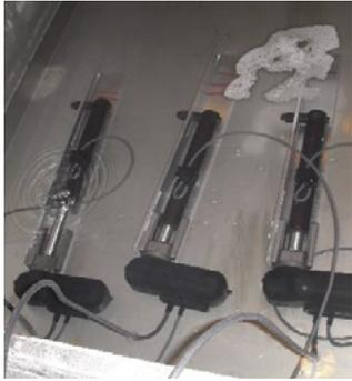
完整的执行器系统暴露在冰水 (ISO 16750-4) 和 Arizona 灰尘 (ISO 20653)中。
