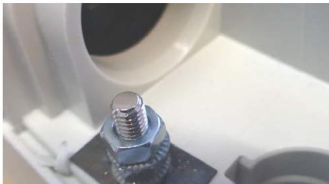
An diesem Pin besteht die Möglichkeit, andere Geräte aus den Anwendungen mit der Erdung zu verbinden. Dies kann auch im Falle von Verbesserungen bei EMV-Messungen helfen.
