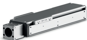
CLSM-92 直线模组 梯形丝杠或滚珠丝杠 配不锈钢护罩
