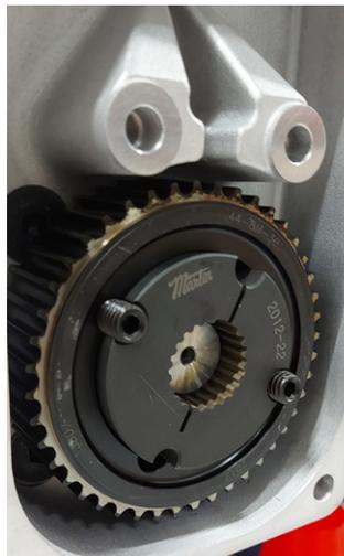
**Schritt 6: Befestigen Sie die Kegelbuchse auf der Lineareinheit.**
