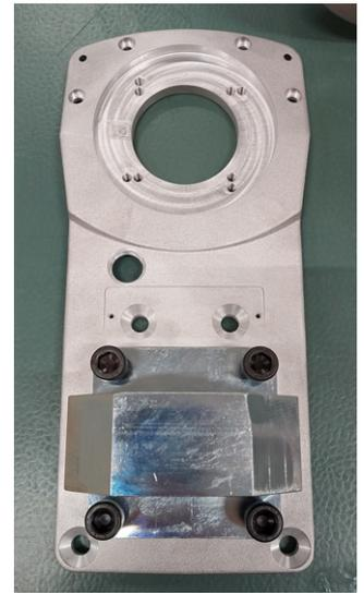
**Schritt 16: Dünne Abdeckung montieren**
