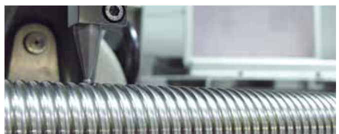
Messung der Steigungsgenauigkeit
