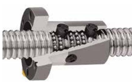
Interne Kuglrückführung über Kugelumlenkung
